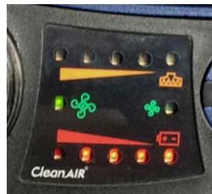
Il display digitale indica all'operatore la velocità di flusso, lo stato di intasamento dei filtri e la durata residua della carica della batteria
