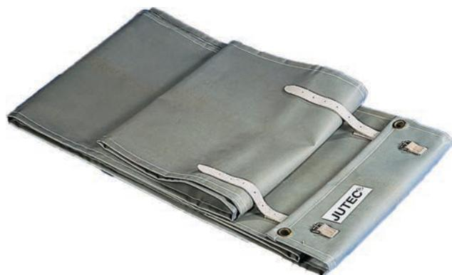
Copertura speciale di protezione per il raffreddamento controllato delle saldature nei tubi. Previene dagli shock termici e protegge da agenti esterni il cordone di saldatura. Sistema di aggancio e sgancio rapido con cinghia e fibbia di fissaggio. Rivestito esternamente in poliuretano idrorepellente, tessuto interno resistente fino a 600°C. Larghezza standard 300mm, diametri variabili da 200 a 1400 mm
