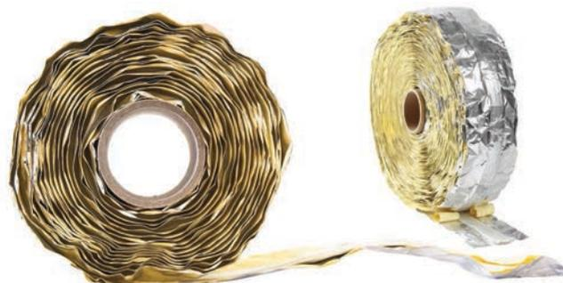
Bobina di nastro adesivo alluminizzato, con fascia centrale in fibra di vetro, da applicare sul rovescio delle parti giuntate per sostenere il bagno di saldatura ed ottenere una saldatura perfetta lavorando su un solo lato. Non causa alterazioni o inquinamenti del bagno di fusione. Perfetta per curvature o pezzi irregolari che hanno difficoltà di accesso. Larghezza 120mm. Rotolo da 30mt.
