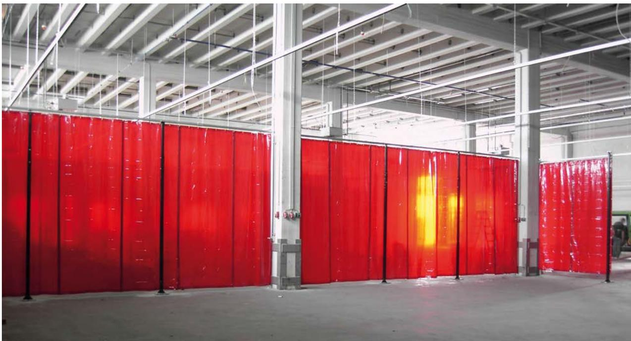
La tenda di protezione Lansarc permette la copertura uniforme su lunghi tratti. Consente la divisione di campate, con eventuale possibilità di apertura per il passaggio di mezzi o lavorati ingombranti, facendo scorrere le tende a lato. Sono un'ottima barriera anche per il freddo, polveri e fumi, presenti in altri reparti.
