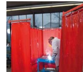
Gli schermi mobili Lansflex 4000 possono essere utilizzati con i due bracci sullo stesso montante per dividere fino a 3 postazioni (soluzione a T) oppure con bracci piegati per creare box ristretti (soluzione a C)
