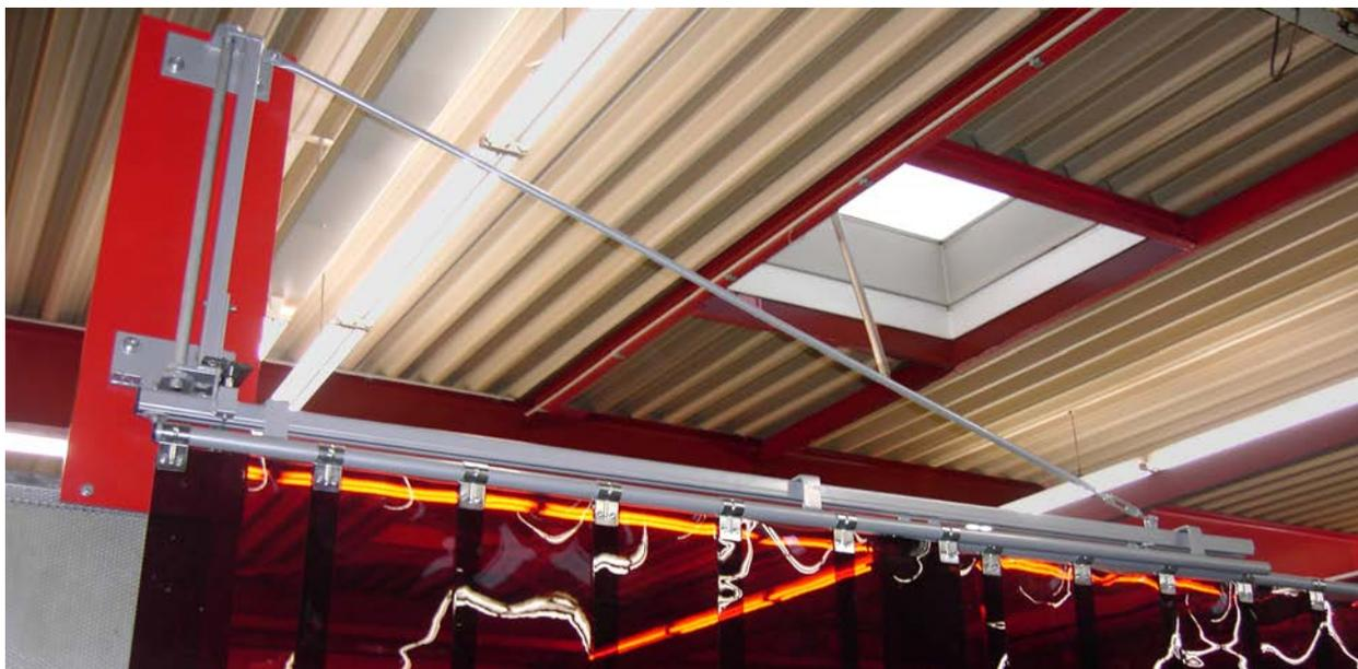
Per facilitare le manovre con carri ponte e muletti all'interno di box di saldatura, le porte a bandiera permettono l'apertura totale degli stessi a 180° consentendo il libero accesso.
