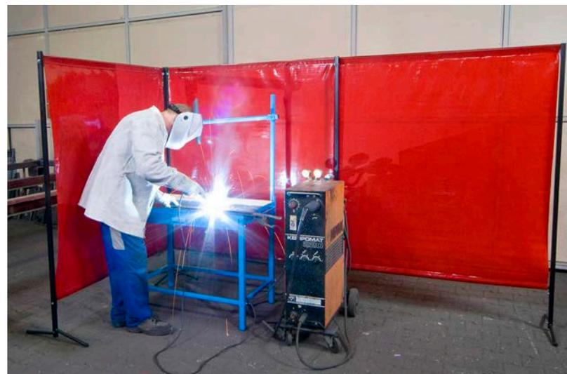
Schermo di protezione mobile in kit d'assemblaggio composto da struttura leggera in tubolare a sezione quadrata, piedini a T e tenda unica, fissata alle doppie barre orizzontali tramite doppio bordo superiore ed inferiore. Piedini predisposti per accostamento in serie. Altezza 2 mt, larghezze disponibili 1460 e 2000 mm spessore 0,4 mm. Disponibili in due colorazioni: OR e R9 **DIN EN ISO 25980:2015-01 (ex1598)**
